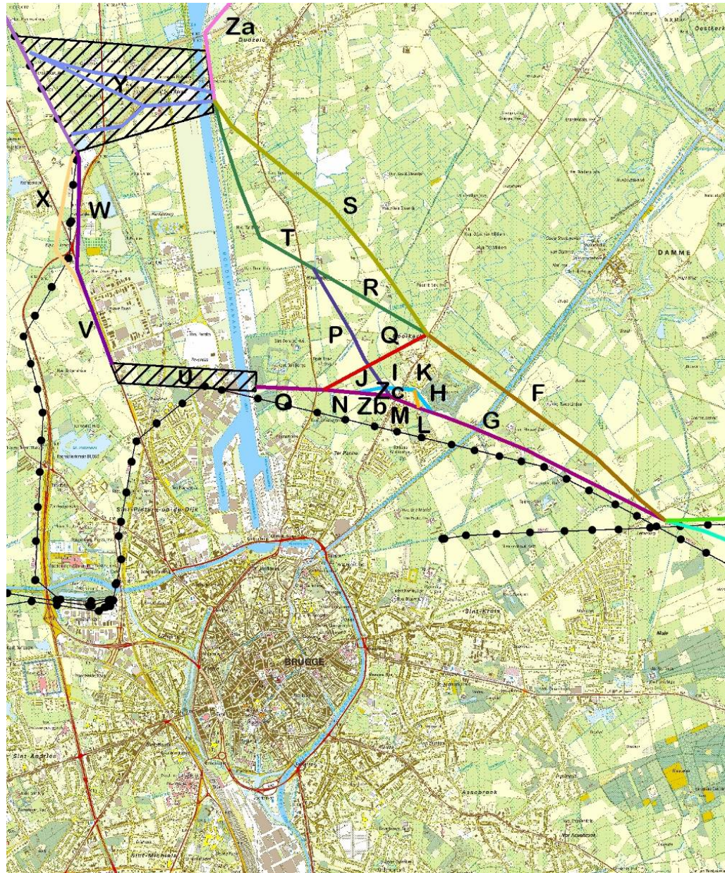
Figuur 16: Tracé-alternatieven (kleur) en bestaande hoogspanningsverbindingen (zwart) van het tracédeel tussen de ostrand en de noordrand van Brugge
